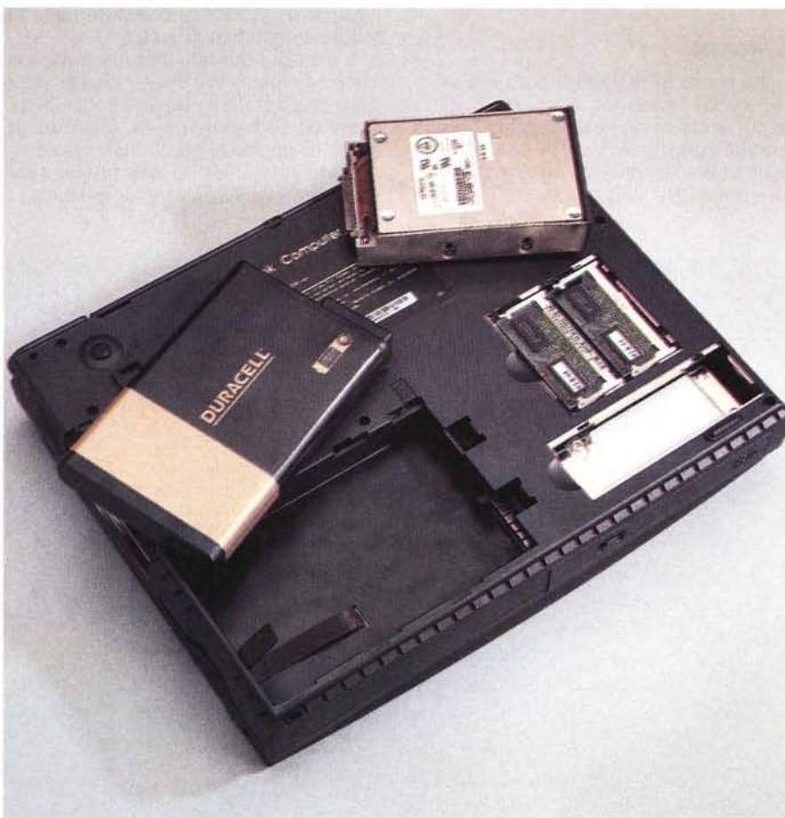
Sotto sopra sono visibili sia l'hard disk removibile, l'espansione di memoria che la batteria ricaricabile.
